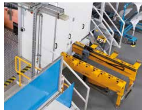
Консоли для смены штампов с приводом для боковой установки штампа в пресс
