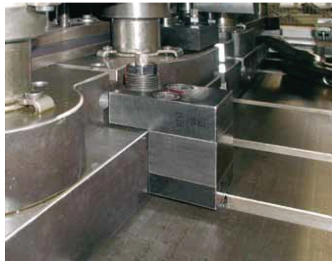
Пример применения механических вставных зажимов, установленных на столе прессы.
