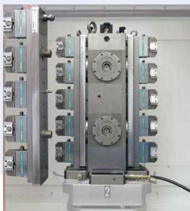
Зажимная система с нулевой точкой, включающая сменные плиты и машинные тиски MC 40 Z
