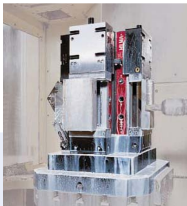
Четырехсторонняя система T125 с гидромеханической силовой передачей
