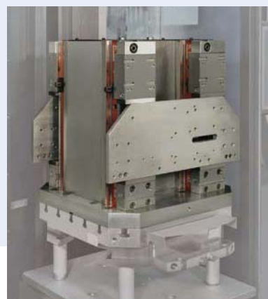
Четырехстор. система VL 125 VarioLine, выполняется по спец. требованиям заказчика
