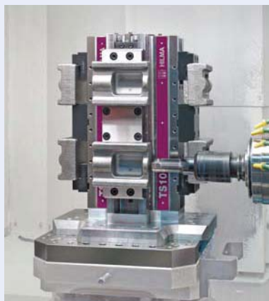
Зажимная башня типа TS 125 с реверсивными ступенчатыми губками
