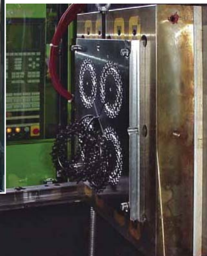
Нагревательная магнитная плита M-TECS 210 устанавливается на машину для литья эластомеров. Распределенная по всей поверхности сила магнитного поля обеспечивает равномерный контакт по всей поверхности и равномерное распределение температуры
