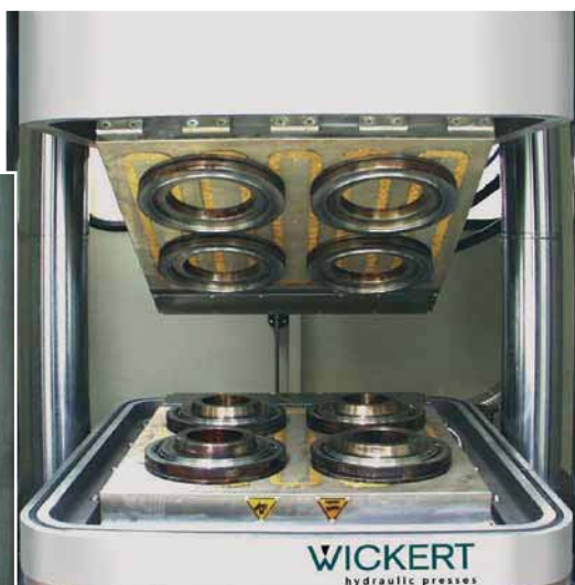
M-TECS 210 на вертикальном прессе – различные пресс-формы на столе пресса без потери полезного пространства из-за зажимных захватов
