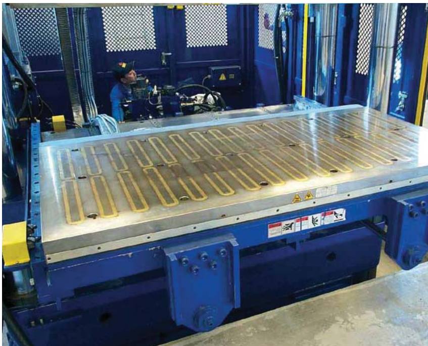
Магнитная зажимная система на вертикальном прессе для температур до 240°C
