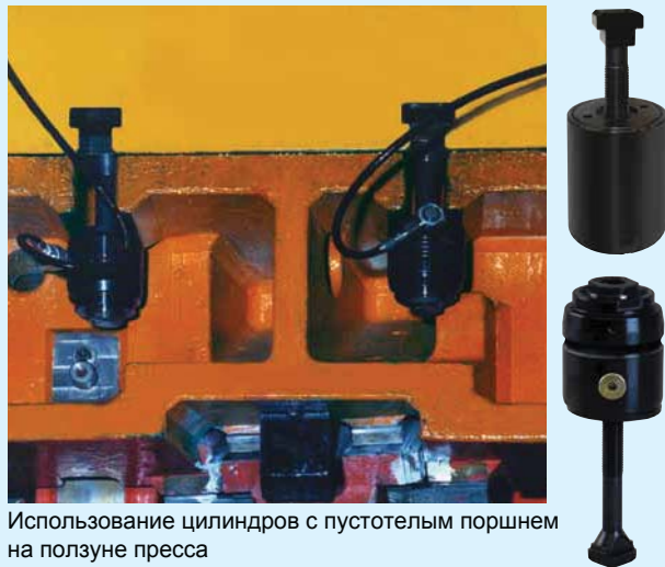
② Зажимные блоки на двухстоечном прессе, установленные на столе и ползуне пресса. Штампы подаются в пресс с помощью поворотных опорных консолей
