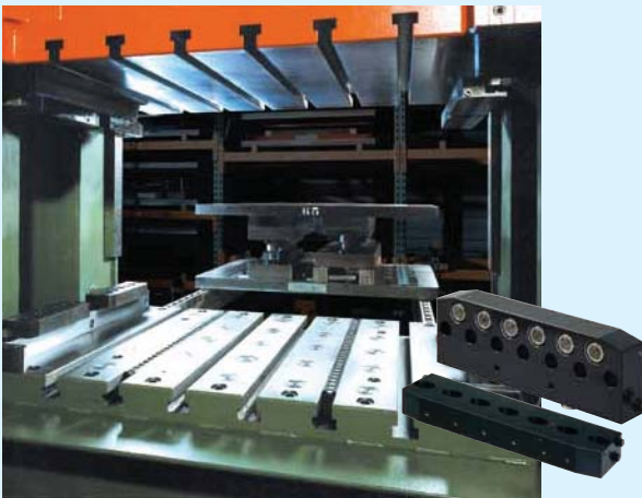
③ Зажимные планки, установленные на столе и ползуне пресса. Легкость подачи штампов обеспечивается с помощью консолей для смены штампов и роликовых направляющих, установленных в Т-образных пазах стола пресса
