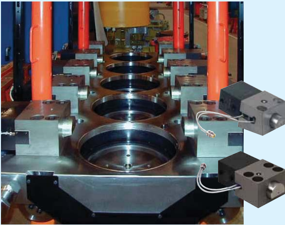
① 5-позиционный штамп для объемной штамповки с клиновыми зажимами (оснащенными гидрораспределителями), обеспечивающими зажим на каждой отдельной позиции
