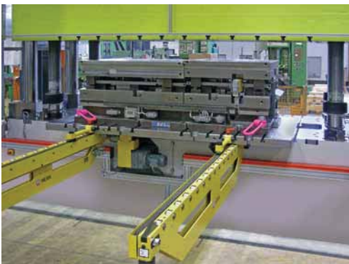
⑰ Система смены штампов, адаптированная к прессу заказчика
