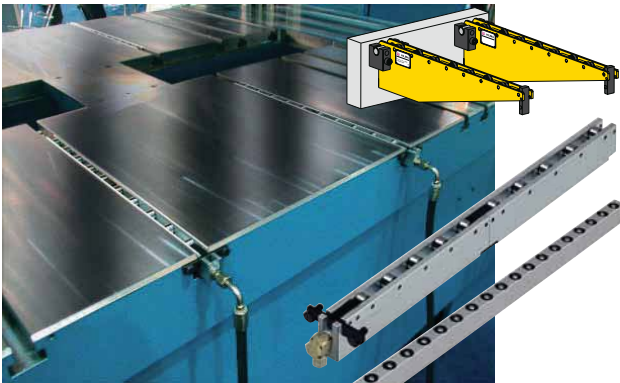
⑮ Роликовые направляющие с гидравлическим подъемом, встроенные в стол пресса
