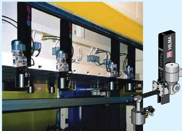
⑥ Система быстрого зажима штампов с цепным толкателем, установленная на ползуне двух-стоечного пресса. Зажимной элемент: цилиндр с пустотелым поршнем
