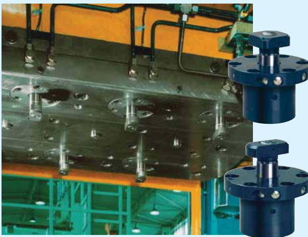
⑨ Поворотные зажимы на двухстоечном прессе. Положение замены штампа: ползун пресса в верхнем положении, поворотные зажимы выдвинуты
