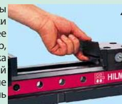
5 Слегка наклоните накладную губку, чтобы преодолеть силу притяжения постоянных магнитов.
