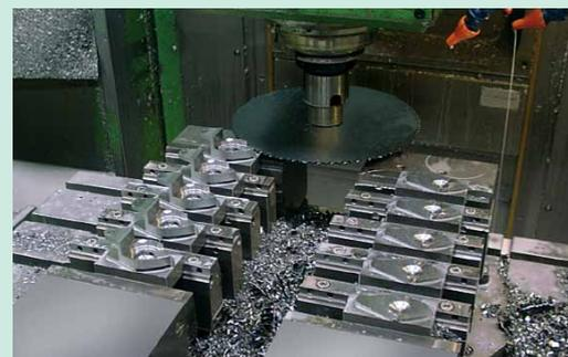
После чистовой обработки «потерянная головка» отделяется от детали с помощью дисковой фрезы.
