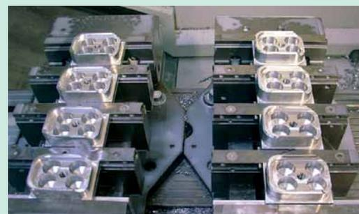
Зажимная кромка фрезеруется на второй ступени зажима.
