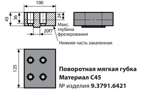
**Система зажимных губок Slim-Flex, цементированных, шлифованных с 8 мм ступенями (свободное пространство для инструмента и стружки). Поставляются с крепежными винтами. Бесступенчато регулируемые накладные губки обеспечивают оптимальный доступ для инструмента без риска столкновения. Минимальный размер зажима 26мм.**
