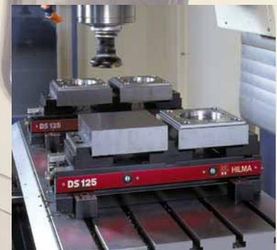
Для единичного производства, а также для малых и средних партий: Двухпозиционная зажимная система DS с механическим приводом для эффективной обработки деталей, имеющих одинаковые или разные размеры. Ручной зажим/разжим, предпочтительно с помощью динамометрического ключа с выбранной силой зажима.
