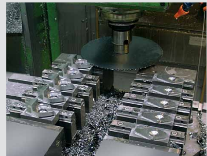
После чистовой обработки «потерянная головка» отделяется от детали с помощью дисковой фрезы.
