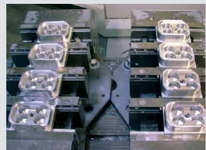
Зажимная кромка фрезеруется на второй ступени зажима.
