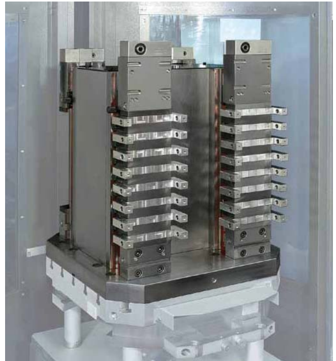
Система VL 125 VarioLine с плавающими центральными губками для многопозиционного зажима
