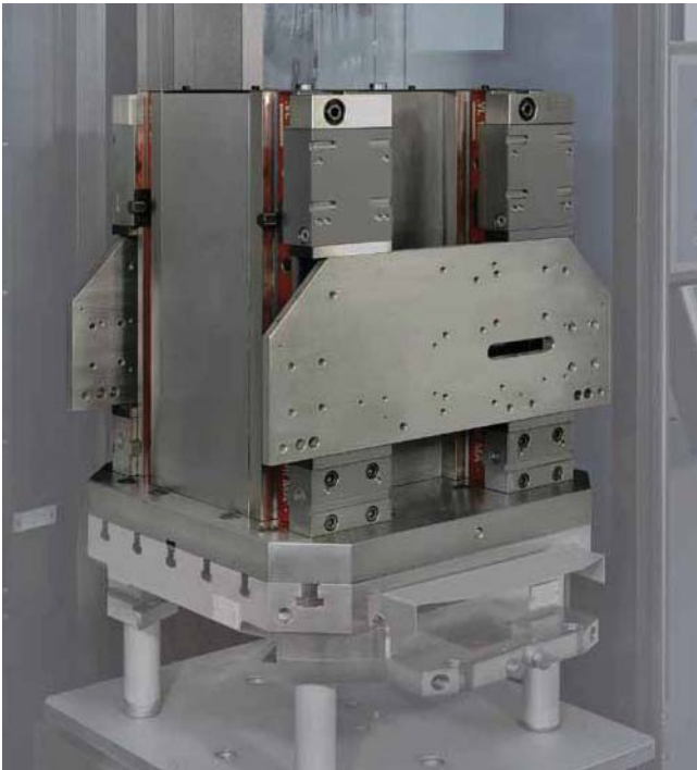
4-сторонняя система на основе зажимной системы VL 125 VarioLine
