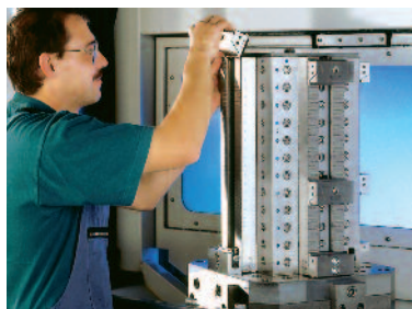
1. Зажимной модуль с разжатым эксцентриковым зажимом вставляется в высокоточный паз
