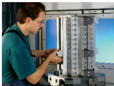
2. Зажимной модуль точно устанавливается на базовом модуле с помощью установочных меток и шкалы.
