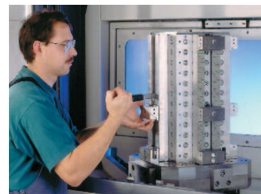
3. Зажимной модуль закрепляется с помощью эксцентрикового винта и динамометрического ключа 50 -70 Нм.
