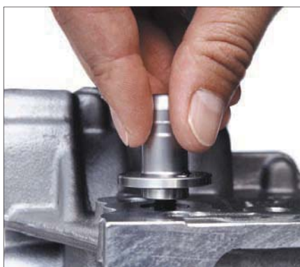
Непосредственный зажим деталей - зажимные ниппели устанавливаются непосредственно в обрабатываемую деталь
