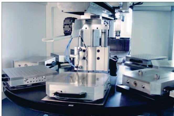
Устройство смены паллет SPW для автоматизированных производств, может подсоединяться к любым обрабатывающим центрам с ЧПУ.
