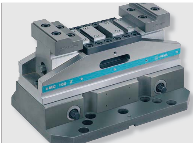
Тиски со SPEEDY metec с усилием зажима 20 кН на одну поз. зажима, идеально для обработки в 5 плоскостях
