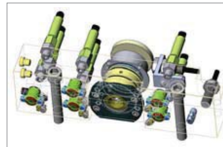
Внешний подсоединительный блок со встроенным зажимным цилиндром для поглощения усилий при подсоединении
