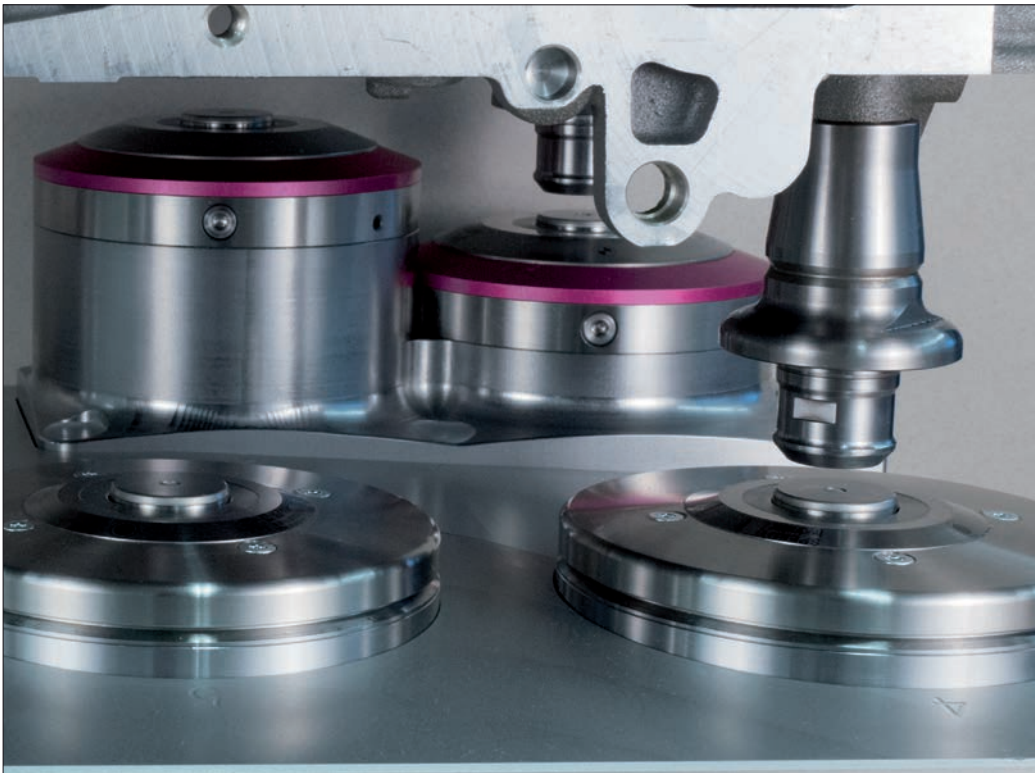
Заготовка с несколькими опорными точками и зажимами
