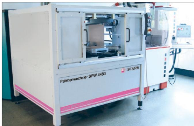
За счет компактности конструкции устройство смены паллет SPW легко устанавливается на обрабатывающие центры с ЧПУ. В зависимости от оборудования может устанавливаться до 8 паллет.
