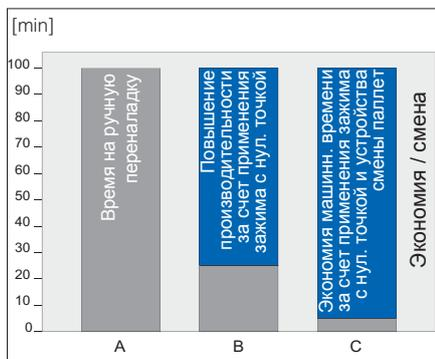
A Переналадка станка с ЧПУ (ручная установка заготовки)
